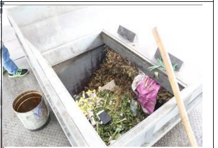
垃圾車、三輪車垃圾收集後傾倒至儲存坑 放置再使用機械壓縮垃圾體積變小
